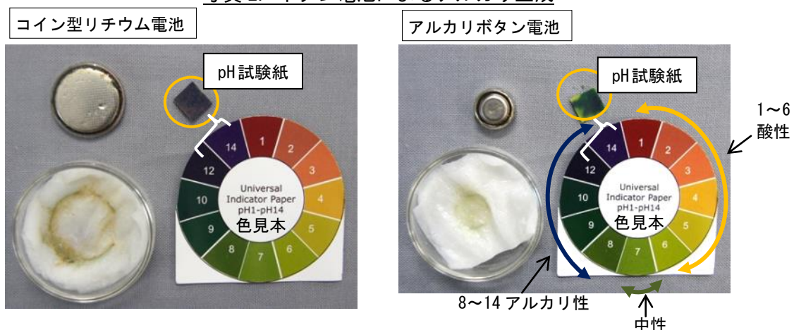
写真 2. ボタン電池によるアルカリ生成 (注 9)
